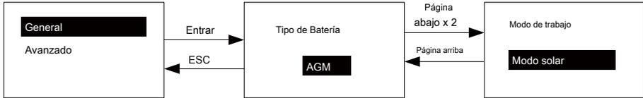
En el modo solar, si la energía solar no es suficiente para alimentar todas las cargas de CA conectadas, la batería suministrará energía a la carga al mismo tiempo hasta que el voltaje descienda al umbral de "inversión a la red".
